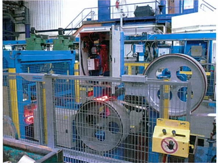
La détentionneuse, développée par Griset, est constituée de plusieurs roues qui déroulent, détensionnent et enroulent les bandes de cuivre. Un rouleau supplémentaire a été placé juste avant l'endroit du contrôle pour stabiliser correctement le laminé et réduire les vibrations.
