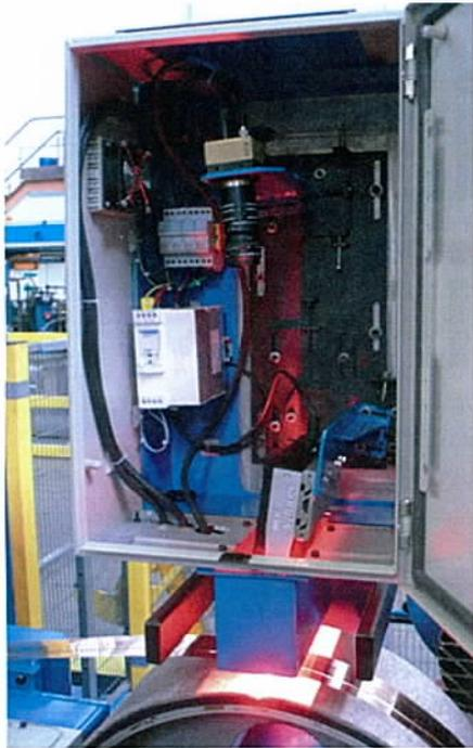
Le poste de contrôle est constitué de deux caméras linéaires de e2V (une pour chaque face du laminé) et d'éclairages à LED d'Effilux. Il fonctionne depuis janvier 2010.
